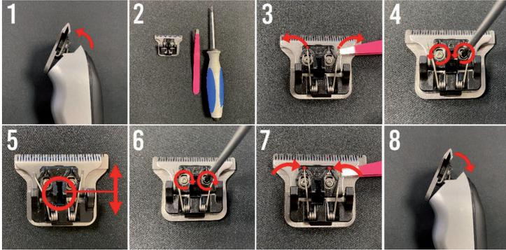
**Ajuste el cabezal de corte en longitud.**
