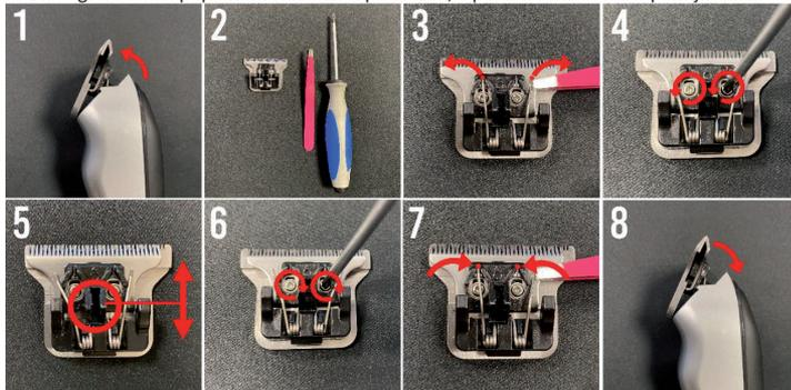
**Rezalno glavo nastavite po dolžini.**
