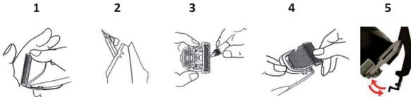
**Leikkuupituuden säätäminen kiinnitettävillä kampaosilla.**
